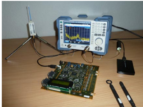
Prinzipieller Messaufbau mit HZ551 und Spektralanalysator
